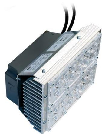
El módulo de 24 LEDs de alta potencia está montado sobre un disipador de aluminio con una combinación de lentes de PMMA que garantizan un grado de protección **IP67**, una alta eficiencia óptica y un óptimo rendimiento de la distribución de la luz.
